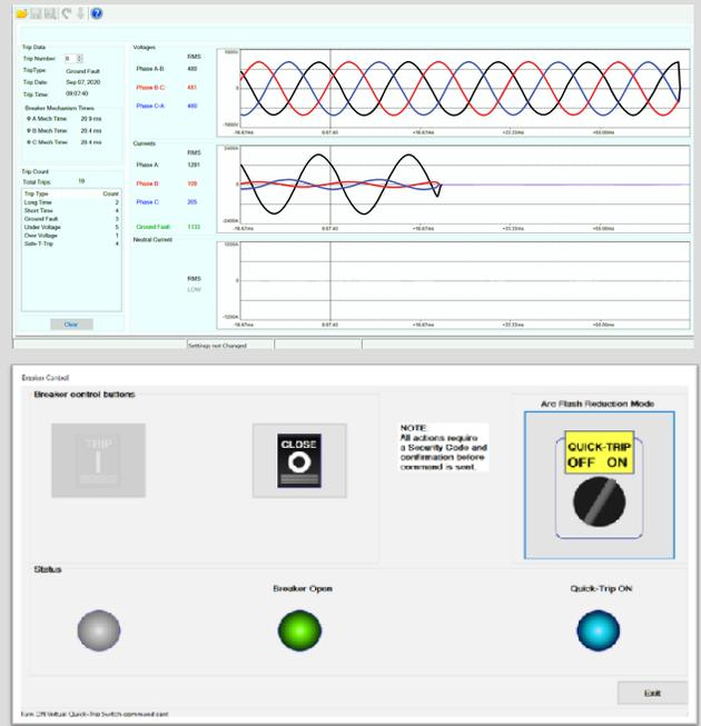
Captura de forma de onda (arriba) y pantalla de control del interruptor (abajo)
