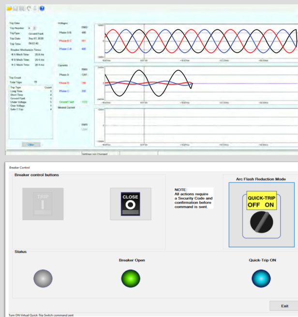
Captura de forma de onda (ilustração superior) e tela de controle do disjuntor (ilustração inferior)
