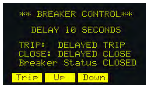
Tela do AC-PRO-NW® com mensagem do atraso do relé
