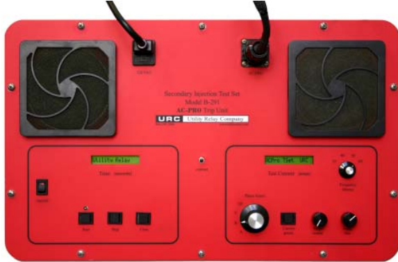
Figure 12.1-1 Dispositif de test d'injection secondaire d'AC-PRO®
